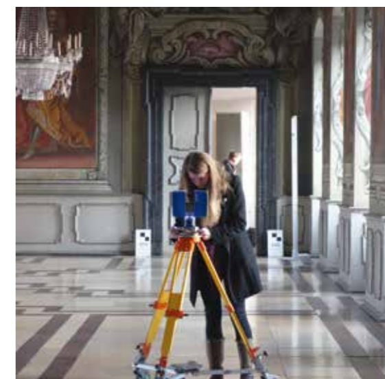
Laserscanning beim Pilotprojekt „Deckenmalerei und 3D“ in der Bamberger Neuen Residenz
