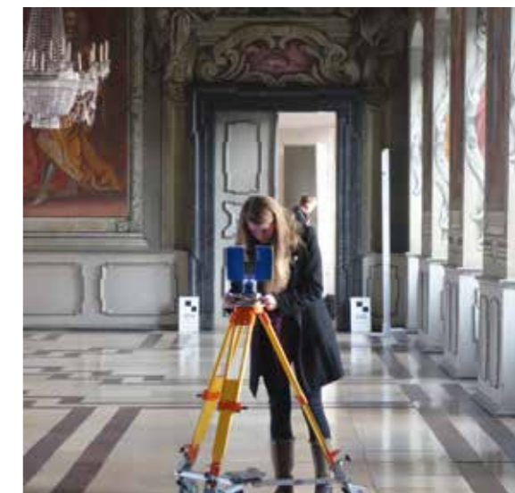
Laserscanning beim Pilotprojekt „Deckenmalerei und 3D“ in der Bamberger Neuen Residenz
